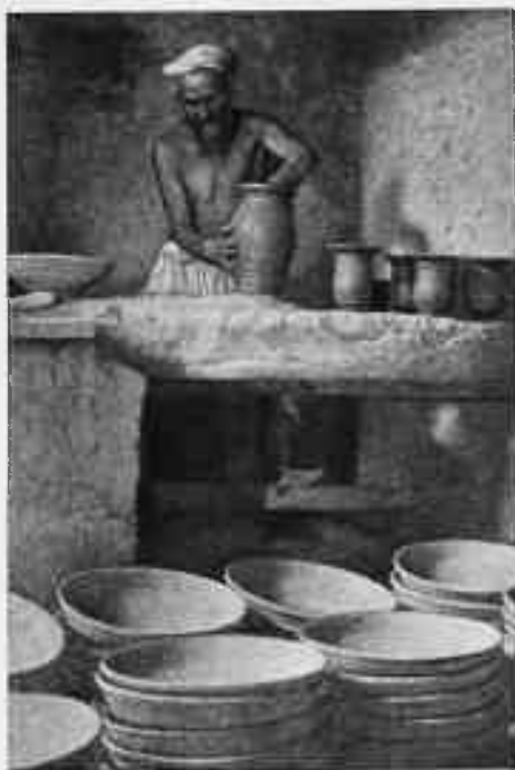
Рис. 11. Мастер за изготовлением кувшина на гончарном кругу.
