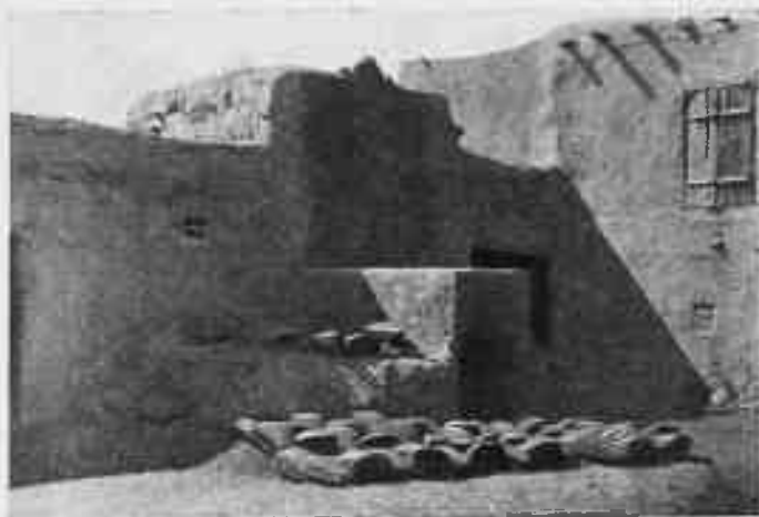
Рис. 3. Чугунолитейная печь. Рядом — формы, подготовленные для отливки лемехов. Фото С. Дудина. ГМЭ.
