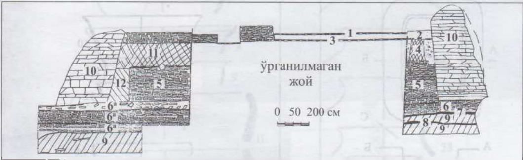
40-расм. Чордона. Шимоли-ғарб – жануби-шарқ бўйича кесим: 1 – III горизонт поли; 2 – поллар ўртасидаги оралик қатма; 3 – IV горизонт поли; 4 – пахса девор; 5 – ғишт билан тикланган платформа (тагкурси); 6 – илк платформа; 6а-платформа остидаги тенглаштирувчи қатлам; 6б-6в – платформанинг давоми (6 – қатлам) ғишт териш ва пахса қўйиш билан бирга аралаш тикланган; 7-8 – кул қатламлари; 9 – оч жигарранг қатлам; 10 – мудофаа девори; 11 – кейинги давр девори; 12 – девор ва платформа ўртасидаги оралик қатлам; 13 – V қурилиш горизонти поли; 14 – казиш ишлари чети.
